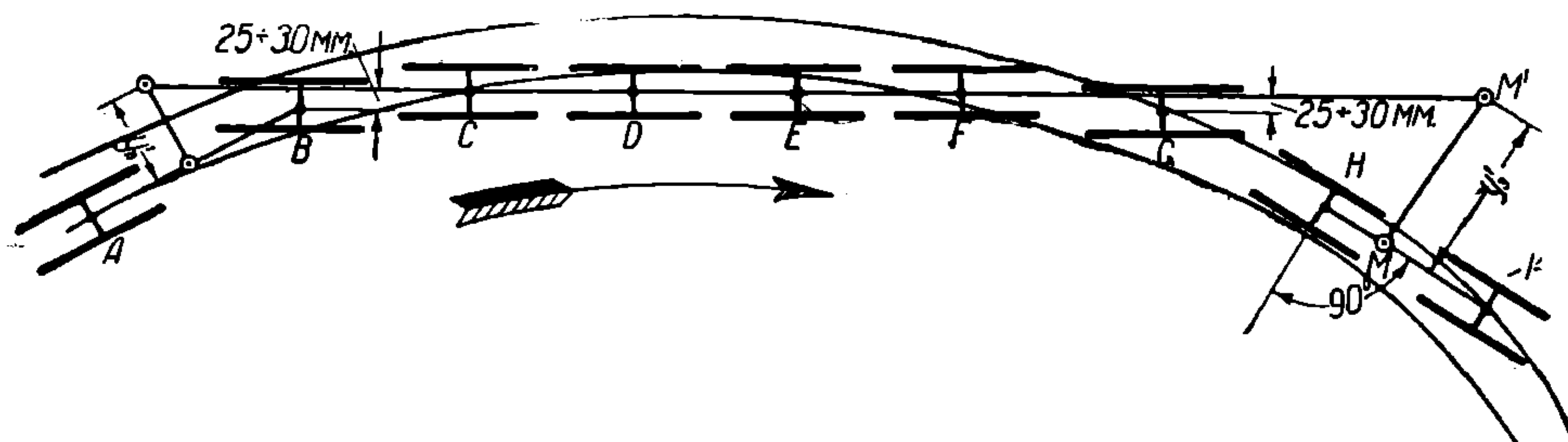
Фиг. 54. Статическое вписывание паровоза типа 1-6-2 на задний ход.
