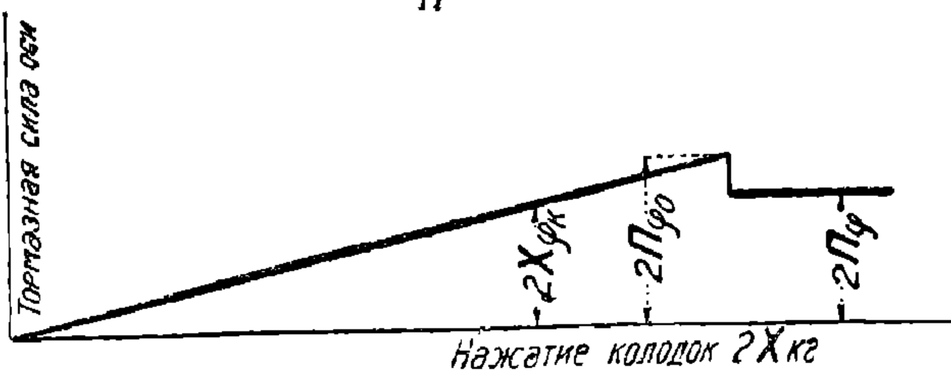
Фиг. 109. Заклинивание колес тормозными колодками.
