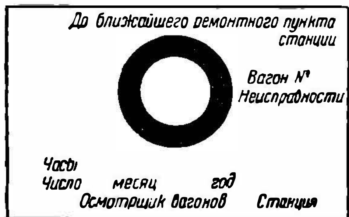
Фиг. 19. Ярлык, наклеиваемый на неисправный вагон, подлежащий пропуску до ближайшей станции с ремонтным пунктом
