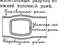
Черт. 17. Эскизъ. Горизонтальный разрѣзь по нижней топочной рамѣ.
