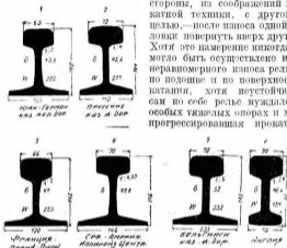
Черт. 53. Формы рельсов 1 : 6. G—вес килограмм./пл. м., W—момент сопротивления см 3 .
