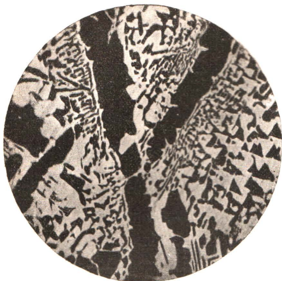
Фиг. 9. — Sb = 70%, Cu = 30%. Компоненты: Sb — бѣлая составляющая. SbCu 2 — черная Кристаллы соединения SbCu 2 и эвтектиче- ская смѣсь.
