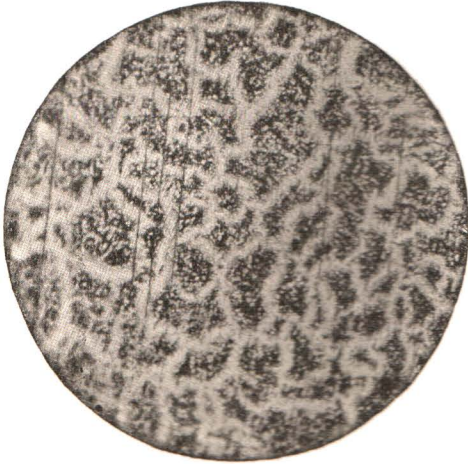
Фиг. 17. — Sb = 45%, Cu = 55%. Сплав медленно охлажденный. Компоненты: SbCu_2 — белая составляющая. SbCu_3 — черная " Распавшийся твердый растворъ.
