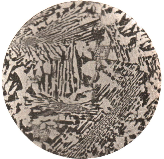
Фиг. 6. — \text{Sb} = 76\% , \text{Cu} = 24\% . Компоненты: \text{Sb} — белая составляющая. \text{SbCu}_2 — черная ” Эвтектическая смесь с небольшим из- бытком сурьмы.
