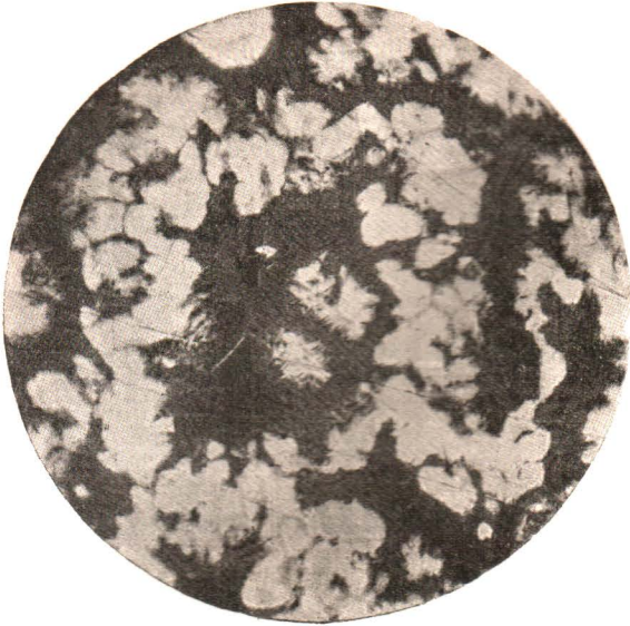
Фиг. 25. — Sb = 44%. Cu = 56%. Сплав медленно охлажденный. Компоненты: SbCu 2 — белая составляющая SbCu 3 — черная Распавшийся твердый раствор.
