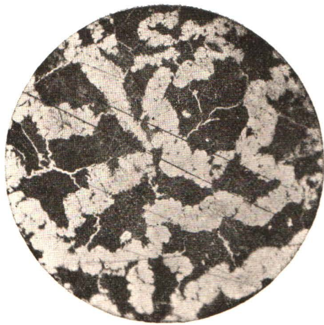
Фиг. 16. — Sb = 43%, Cu = 57%. Сплав медленно охлажденный. Компоненты: SbCu_2 — белая составляющая. SbCu_3 — черная Распавшийся твердый раствор.
