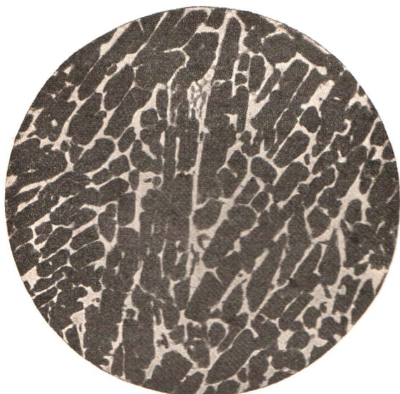
Фиг. 11. — Sb = 55%, Cu = 45%. Компоненты: Sb — бѣлая составляющая. SbCu 2 — черная Кристаллы соединения SbCu 2 .
