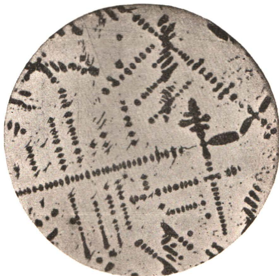
Фиг. 14. — Sb = 30%, Cu = 70%. Компоненты: Cu — черная составляющая. Тв. р. ( SbCu_3 + Cu ) — белая Кристаллы меди и твердый раствор.
