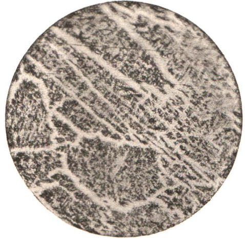
Фиг. 18. — Sb = 45,5%, Cu = 54,5%. Сплав медленно охлажденный. Компоненты: SbCu_2 — белая составляющая. SbCu_3 — черная " Распавшийся твердый растворъ.
