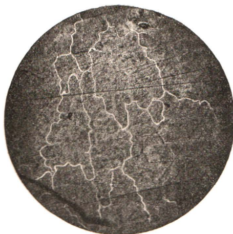
Фиг. 12. — Sb = 45%, Cu = 55%. Сплавъ быстро-охлажденный. Твердый растворъ сурьмы и соединения SbCu 2 . Смѣшанные кристаллы -- форма β.
