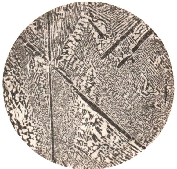
Фиг. 8. — \text{Sb} = 76\% , \text{Cu} = 24\% . Компоненты: \text{Sb} — белая составляющая. \text{SbCu}_2 — черная ” Кристаллы соединения \text{SbCu}_2 и эвтектиче- ская смесь.
