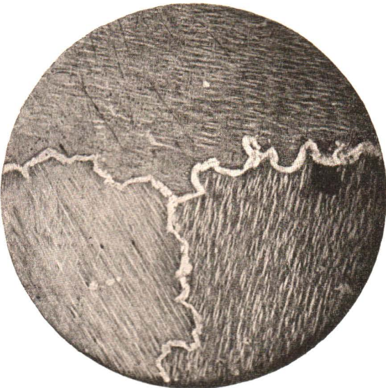
Фиг. 27. — Sb = 46,5%. Cu = 53,5%. Сплав быстро охлажденъ послѣ первой остановки. Начало распаденія предѣльнаго твердаго раствора (SbCu 3 + Sb).
