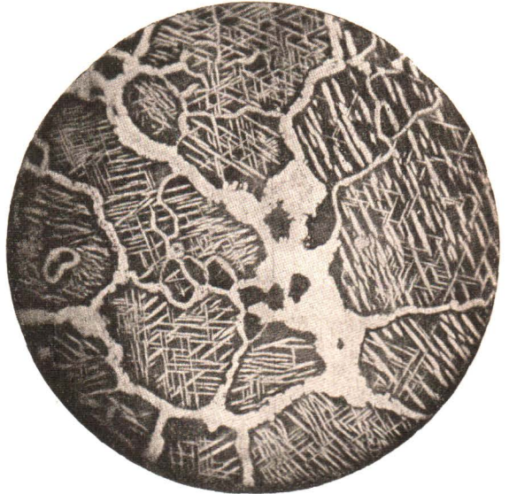
Фиг. 28. — Sb = 47%. Cu = 53%. Сплав быстро охлажденъ тотчасъ послѣ затвердѣванія. Компоненты: SbCu 2 — белая составляющая. SbCu 3 — черная Соединеніе SbCu 2 и предѣльный твердый растворъ, начавшій распадаться.
