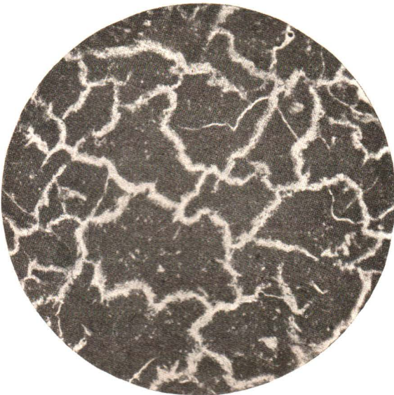
Фиг. 23. — Sb = 41%, Cu = 59%. Сплав медленно охлажденный. Компоненты: SbCu_2 — белая составляющая. SbCu_3 — черная Распавшийся твердый раствор.
