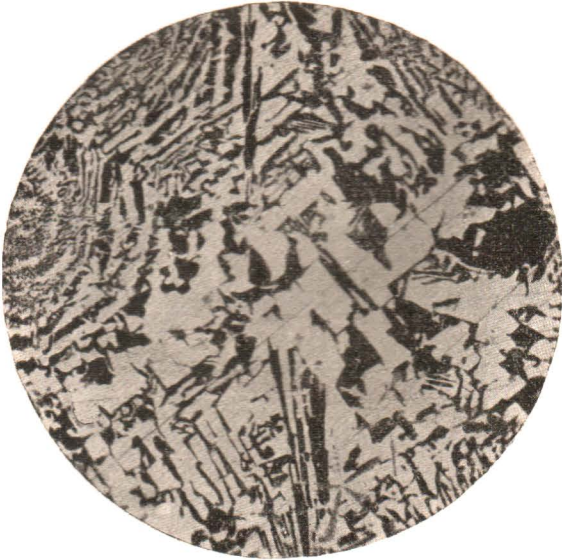
Фиг. 5. — \text{Sb} = 76\% , \text{Cu} = 24\% . Компоненты: \text{Sb} — белая составляющая. \text{SbCu}_2 — черная ” Кристаллы сурьмы и эвтектическая смесь.
