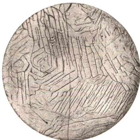
Фиг. 15%. — Sb = 39 и Cu = 61%. Сплав медленно охлажденный. Определенное химическое соединение SbCu_3 —форма \alpha .
