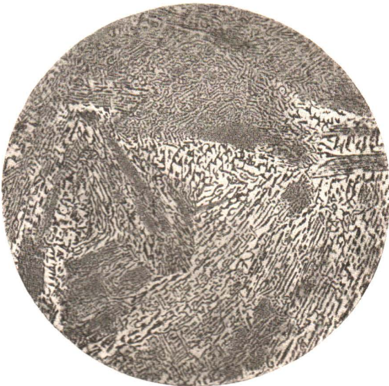
Фиг. 7. — \text{Sb} = 76\% , \text{Cu} = 24\% . Компоненты: \text{Sb} — белая составляющая. \text{SbCu}_2 — черная ” Эвтектическая смесь.
