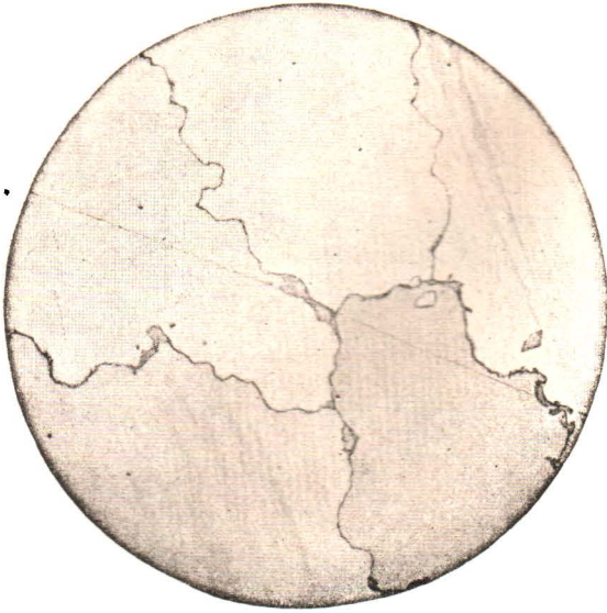
Фиг. 29.— Sb = 36,5%. Cu = 63,5%. Сплавъ быстро охлажденный. Твердый раствор (SbCu 3 + Cu).
