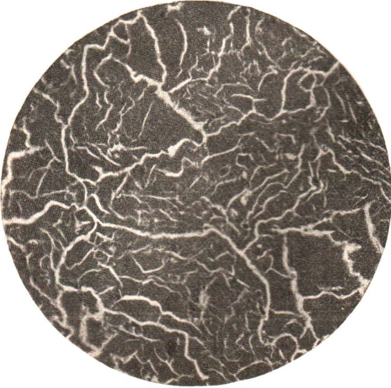
Фиг. 21. — Sb = 40%, Cu = 60%. Сплав медленно охлажденный. Компоненты: SbCu_2 — белая составляющая. SbCu_3 — черная Распавшийся твердый раствор.
