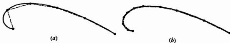
Рис. 1. Точечное представление кривых, (а) Равномерная плотность точек вдоль кривой; (б) плотность точек возрастает с уменьшением радиуса кривизны.
