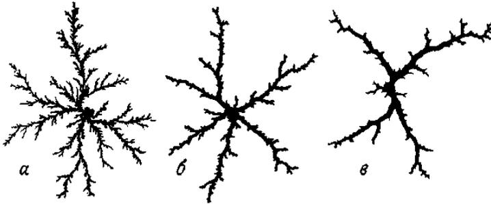
РИС. 10. Фотографии двумерных структур, возникающих при химическом растворении пористого пластика радиальным потоком воды при различных скоростях инъекции: а)  $48 \text{ см}^3/\text{ч}$ ; б)  $4 \text{ см}^3/\text{ч}$ ; в)  $2 \text{ см}^3/\text{ч}$ .
