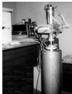
Рис. 1.14. Слева – функциональная схема растрового сквид-микроскопа: 1 – исследуемый образец, 2 – координатный стол, 3 – узел управления столом, 4 – чувствительные элементы на сквидах, 5 – хладопровод, 6 – жидкий азот или гелий, 7 – криостат, 8 – электронный блок; справа – растровый микроскоп ССМ-77
