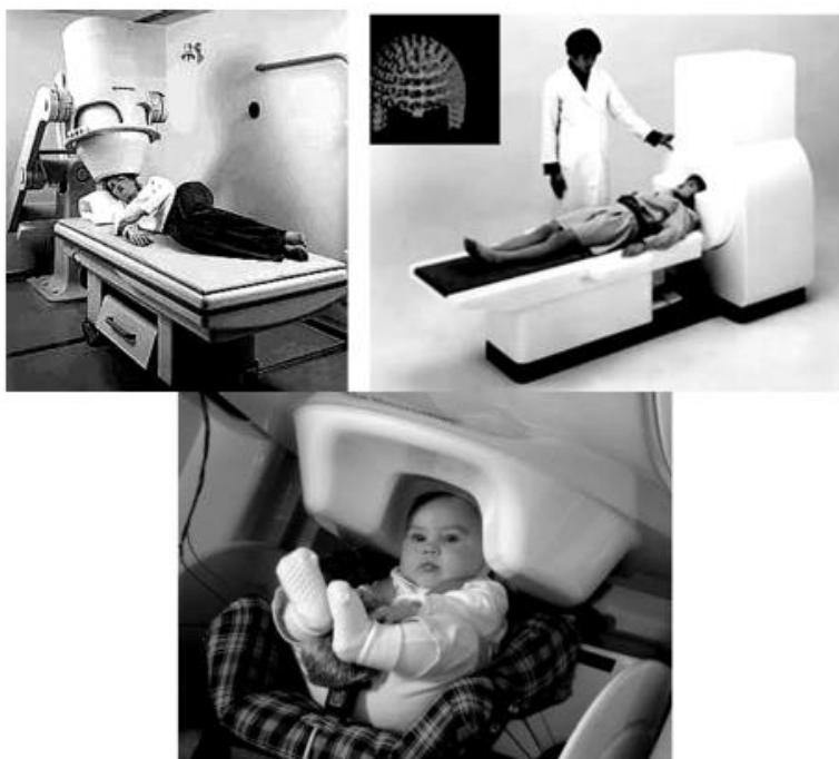
Рис. 1.13. Различные варианты реализации магнитоэнцефалографа на сквидах и схема фиксации активности отдельных участков мозга пациента (на вставке вверху в центре)
