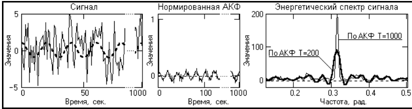
Рис. 18.57. Вычисление энергетического спектра сигнала по АКФ разной длины.
