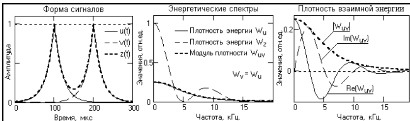
Рис. 18.46. Форма и энергетические спектры сигналов.
