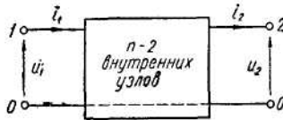
Рис. 2.7. Электрическая схема с одним входом и одним выходом, которые имеют общий узел O .
