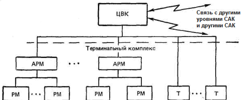
Рис. 5.85. Общая структура КТС САК: РМ — рабочее место; Т — терминал
