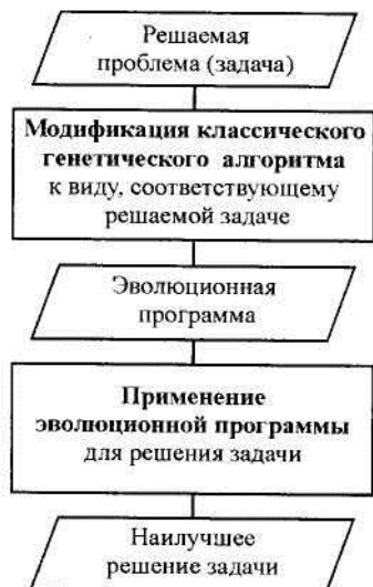
Рис. 5.3. Решение задачи с помощью эволюционного алгоритма (эволюционной программы)
