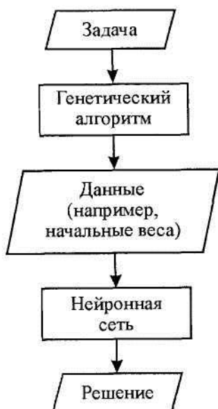
Рис. 5.54. Вспомогательное объединение генетического алгоритма с нейронной сетью.
