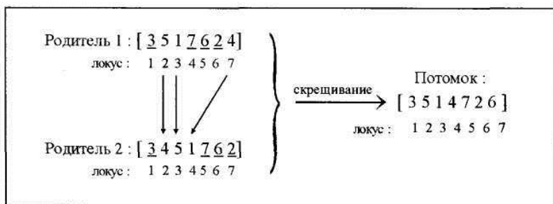
Рис. 5.47. Скрещивание с сохранением порядка в генетическом алгоритме программы Evolver .
