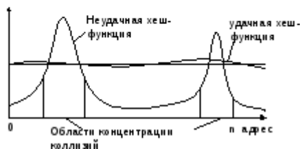
Рис. 8.2. Распределение коллизий в адресном пространстве таблицы.
