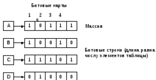
Рис. 8.10. Организация вспомогательной структуры данных в виде битовых карт.
