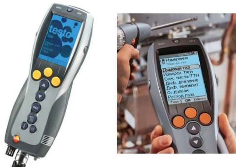
Рис. 17.6. Слева – общий вид портативного анализатора дымовых газов "Testo 330-3", справа – сенсор в процессе работы со сменным электрохимическим зондом
