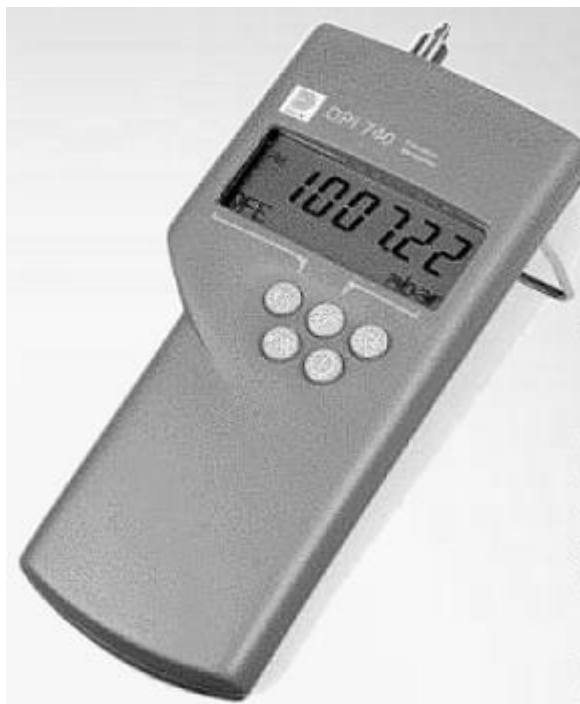
Рис. 2.8. Портативный прецизионный цифровой манометр давления DPI 740. Размер 190x90x36 мм, масса 0,5 кг. Диапазон рабочих температур от –10 С до +50 С. Класс точности 0,02%. Долговременная стабильность 0,01% за год
