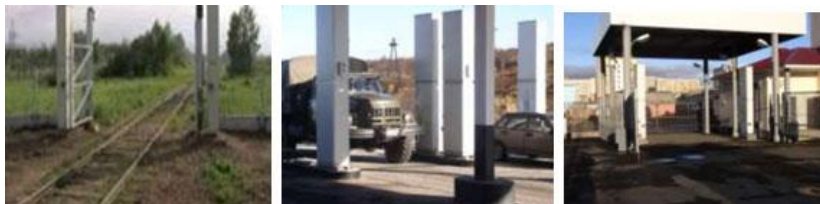
Рис. 22.9. Пример мест установки радиационного монитора-идентификатора ИР-560
