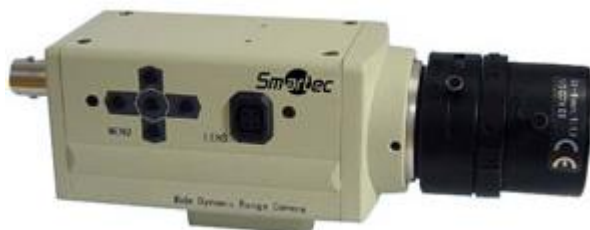
Рис. 11.6. Цветная камера видеонаблюдения STC-2008. Размеры 42x42x86,5 мм.
