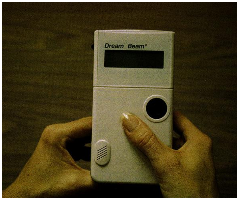
Рис. 20.2. Вид прибора "Dream Beam" для неинвазивного измерения сахара крови, разработанного фирмой Futrex
