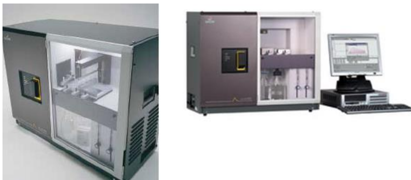
Рис. 23.7. Интеллектуальный ППР сенсор "Biacore 3000": слева – сенсорный блок, справа – общий вид
