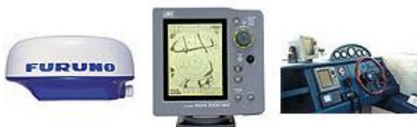
Рис. 13.10. Один из компактных современных радиолокаторов для небольших судов Furuno M1712: слева – антенна с генератором радиоимпульсов ("сканер"); по центру – индикатор с блоком селекции и обработки сигналов; справа – фото индикатора, встроенного в пульт управления яхтой
