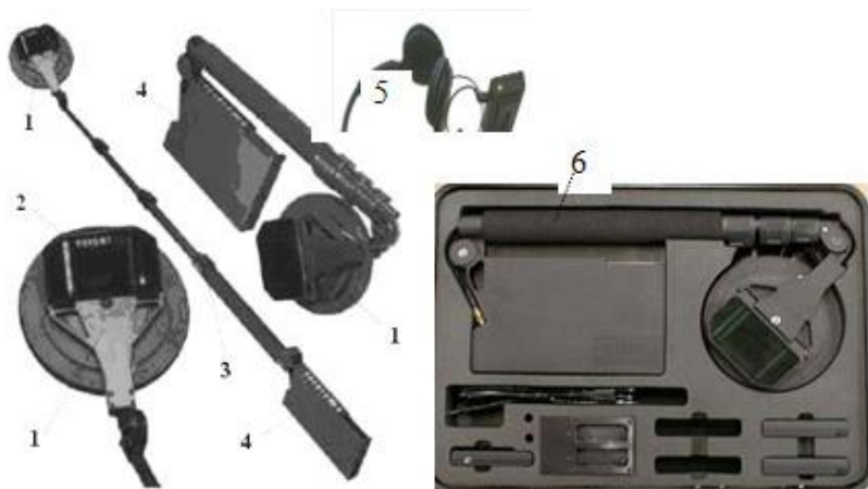
Рис. 13.15. Нелинейный радиолокатор Orion NGO-4000: 1 – антенна с дисплеем; 2 – дисплей; 3 – раздвижная штанга; 4 – основной блок; 5 – наушники; 6 – кейс для упаковки радиолокатора (общая масса 1,6 кг)
