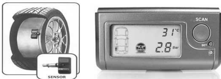
Рис. 2.7. Система контроля давления и температуры в шинах автомобилей. Слева – микроэлектронный сенсор давления и температуры воздуха в автомобильных шинах. Масса 32 г. Срок службы батареи 5 лет. Справа – центральный блок индикации и сигнализации
