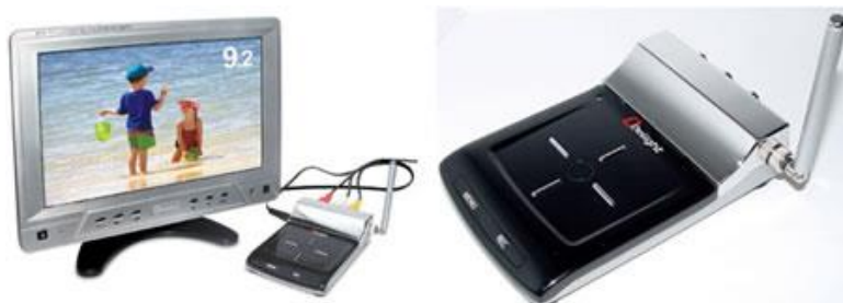
Рис. 14.2. Мобильный ТВ тюнер G-WWT-1201B с малогабаритным экраном. Справа показан тюнер в увеличенном виде
