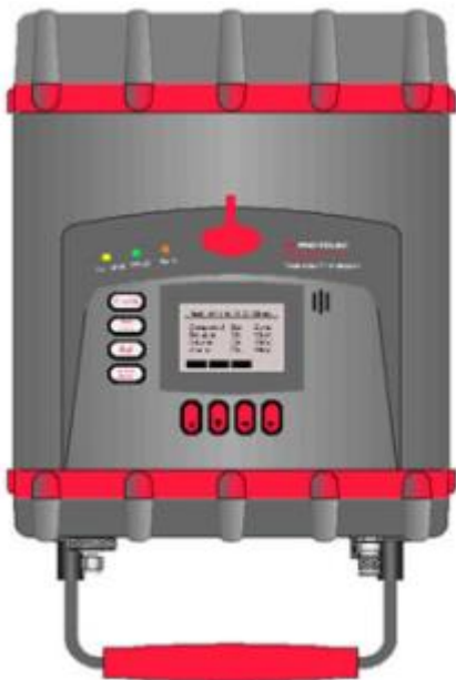
Рис. 4.10. Портативный газовый хроматограф Voyager. Размеры 39х27х15 см; масса (с аккумуляторной батареей на 9 ч. непрерывной работы) – 6,8 кг. Жидкокристаллический дисплей 128х64 пикселей. Интерфейс RS232 для соединения с принтером или ПЭВМ
