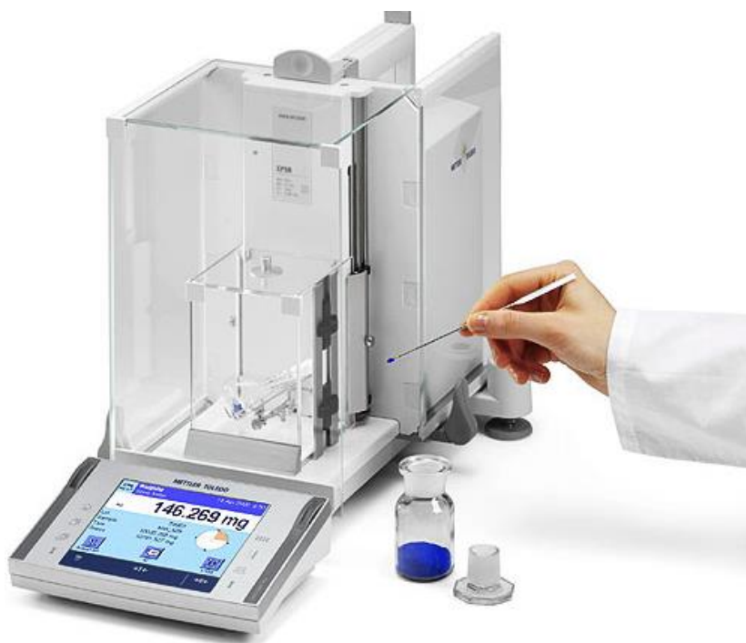
Рис. 7.14. Высоточные микровесы компании Метлер Толедо. Взвешивание массы до 52 г с дискретностью 1 мкг. Габаритные размеры 263 x 490 x 322 мм
