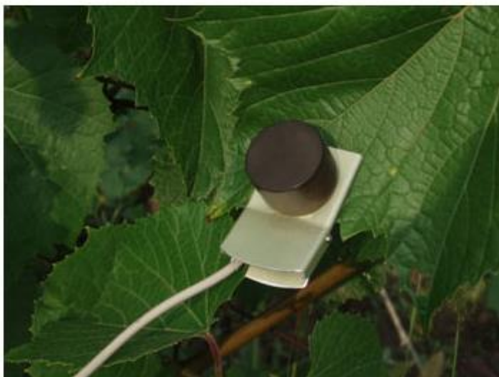
Рис. 20.7. Вверху – конструкция оптоэлектронной головки для определения плотности хлорофилла в листьях растений; внизу – головка в действии
