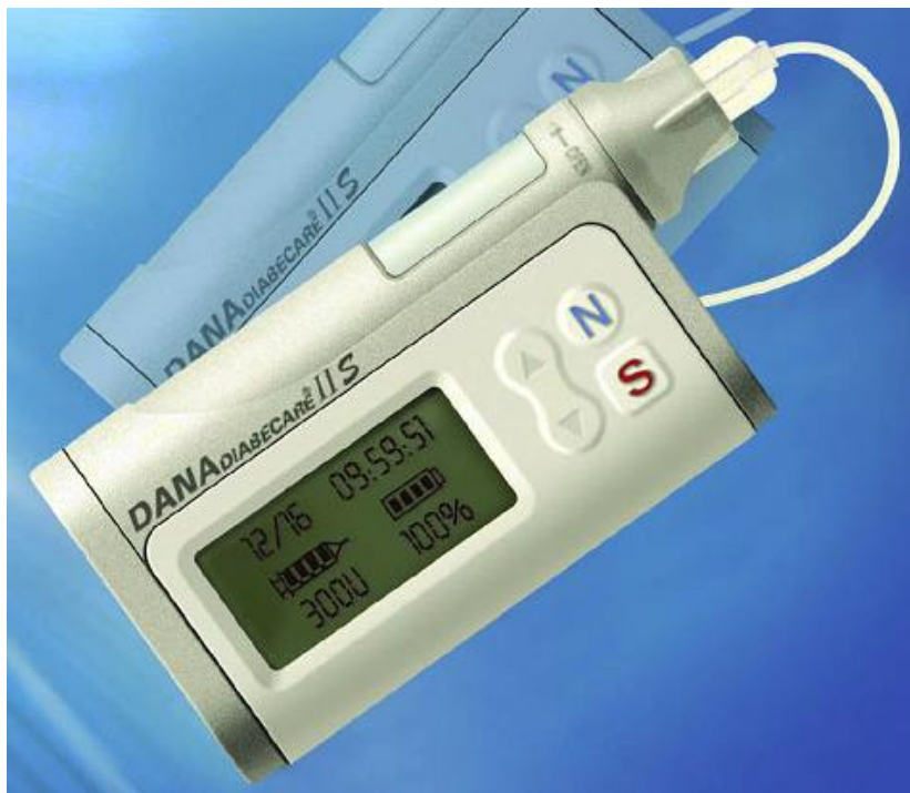
Рис. 17.9. Портативная инсулиновая помпа DANA Diabecare IIS со встроенным глюкометром: 1 – отделение для инсулинового резервуара; 2 – окошко для определения оставшегося количества инсулина; 3 – кнопки управления; 4 – ЖК дисплей; 5 – коннектор для прикрепления инфузионного набора; 6 – пластиковый катетер
