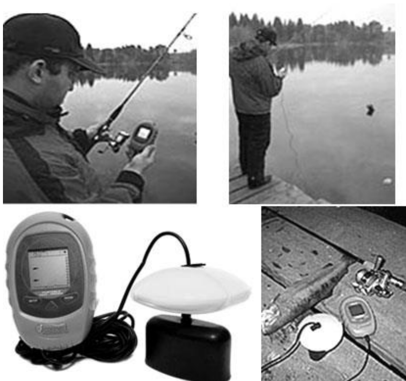
Рис. 6.11. Портативный рыбопоисковый эхолот JJ-CONNECT Fisherman 140. Вверху - эхолот в действии во время рыбалки с берега, внизу - общий вид составных частей эхолота
