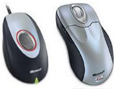
Рис. 11.19. Компьютерные "мышки" со встроенным чувствительным сканером дактилоскопического сенсора
