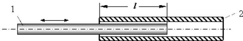
Рис. 8.7. Цилиндрический конденсатор с подвижной сердцевиной как сенсор линейного перемещения
