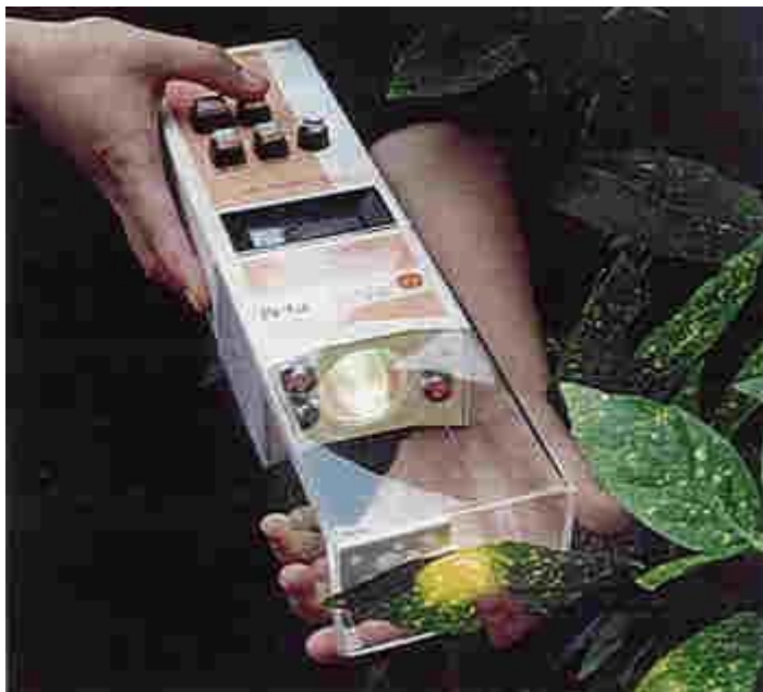
Рис. 22.1. Измеритель эффективности фотосинтеза EARS-PPM нидерландской фирмы EARS. Размеры – 250x53x80 мм, масса – 0,85 кг
