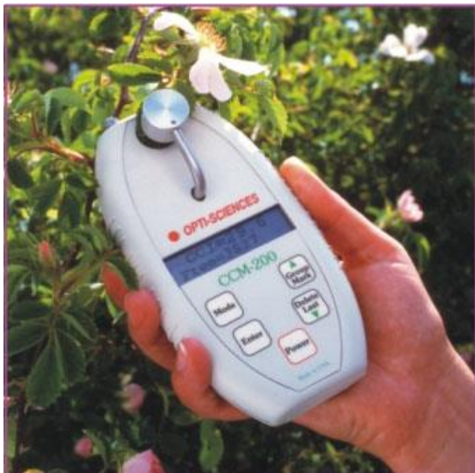
Рис. 20.8. Сенсор для измерения содержания хлорофилла в листьях растений фирмы Opti-Sciences (США). Размеры 152 x 82 x 25 мм, масса 162 г
