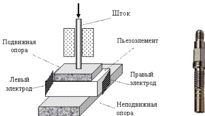
Рис. 9.1. Слева – одна из конструкций чувствительного элемента пьезоэлектрического сенсора силы; справа – внешний вид сенсора силы серии 9215 фирмы Kistler
