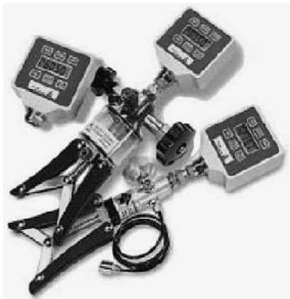
Рис. 2.9. Портативные цифровые калибраторы давления РМ110L и РМ110Н. Размер цифрового манометра 98х92х33 мм, масса 0,5 кг. Диапазон рабочих температур от –10 С до +50 С. Класс точности 0,05 %. Долговременная стабильность 0,01% за год
