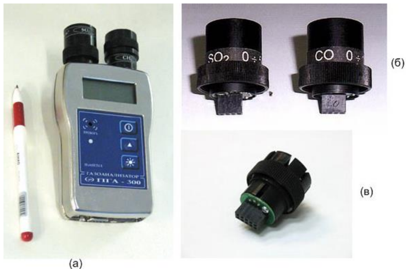
Рис. 15.5. Персональный газоанализатор ПГА-300: а) общий вид; б) электрохимические газовые датчики; в) термокаталитический датчик
