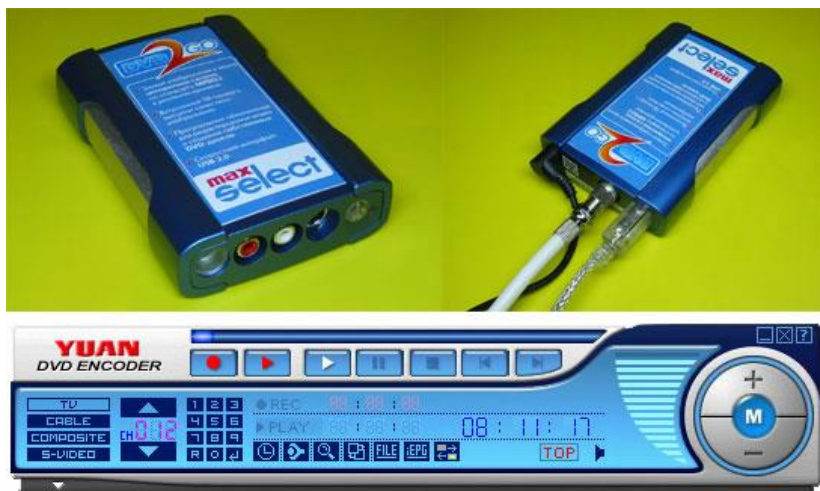
Рис. 14.5. Портативный компьютерный ТВ тюнер MaxSelect DVD2Go; снизу - изображение на экране компьютера после запуска программы управления тюнером
