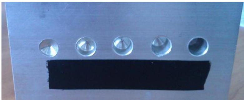
Если тепловое излучение отражается от одной поверхности, 20% излучения поглощается и 80% отражается. Так происходит на внешней плоской поверхности блока. Но в отверстиях все не так. Отраженные 80% снова отражаются внутренней поверхностью отверстия, 20% излучения поглощается и 80% отражается (уже 67% от первоначального излучения). Количество последующих переотражений зависит от глубины и формы отверстия.
