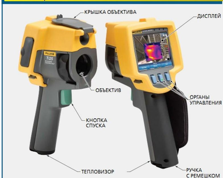
Рис. 2-4. Обычные тепловизоры имеют несколько общих компонентов, к которым относятся объектив, крышка объектива, дисплей, органы управления и ручка с ремешком
