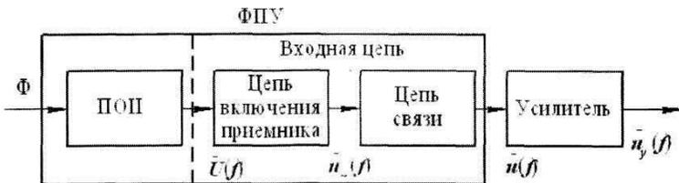
Рис. 29.1. Блок-схема включения приемника излучения и усилителя в тепловизионных ОЭС:
