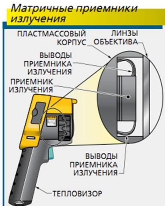
Рис. 2-2. Матричный приемник излучения (матрица в фокальной плоскости, FPA) – это устройство получения изображения, состоящее из массива (обычно прямоугольного) чувствительных к излучению пикселей, расположенных в фокальной плоскости объектива.
