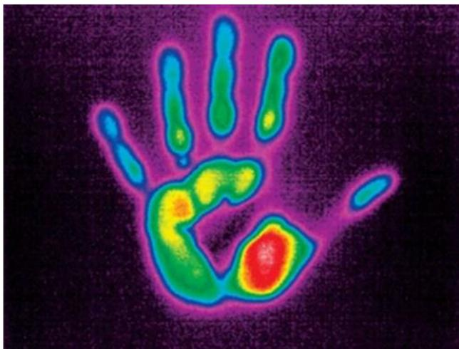
*Тепловое изображение остаточного тепла, переданного рукой при прикосновении к поверхности окрашенной стены, легко обнаружить с помощью тепловизора.*
