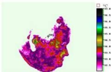
Разрешение  $160 \times 120$ , чувствительность  $100\text{ мК}$ . Чувствительность  $100\text{ мК}$  подходит для случаев температурного диапазона более  $10^{\circ}\text{C}$ . При сужении диапазона качество изображения существенно падает.
