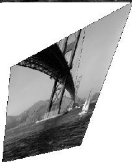
Рис.5.6. Действие билинейного геометрического преобразования на исходный снимок; параметры преобразования: x' = 0.1x + 0.9y + 0.002xy , y' = 0.2x + 1.1y + 0.0022xy
