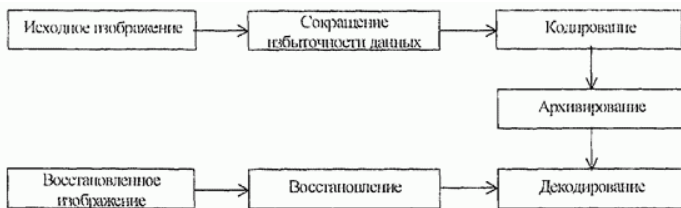
Рис. 11.1. Сжатие и восстановление данных (блок-схема)
