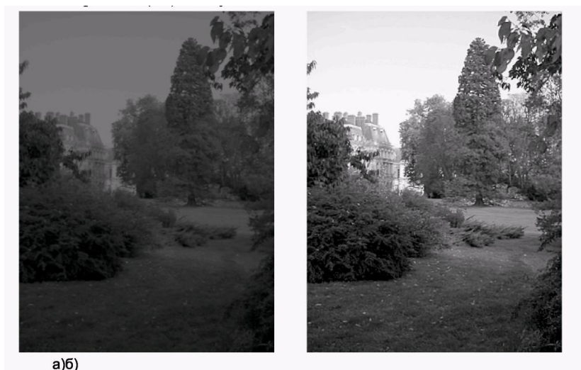
Рисунок 10.1 а) Исходное изображение; б) автоматическое контрастирование (при 0,005 квантилях слева и справа).
