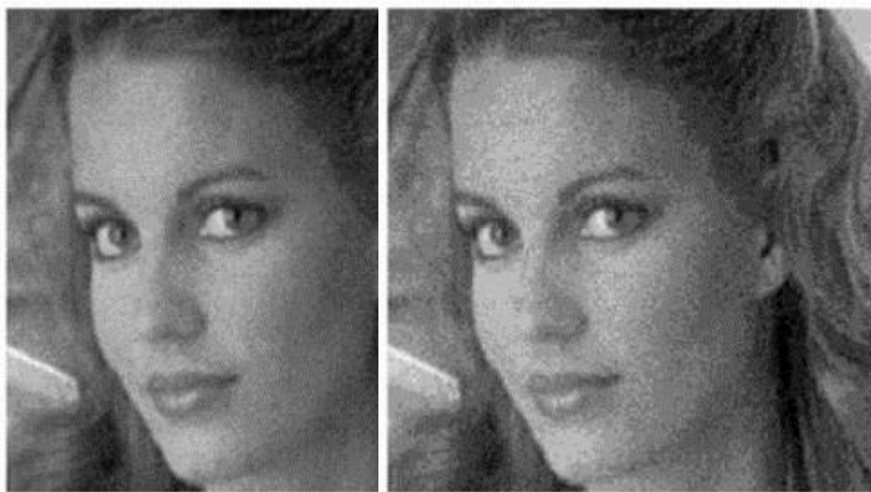
а) б) Рис.1.15. Результаты равномерного квантования с предварительным добавлением шума
