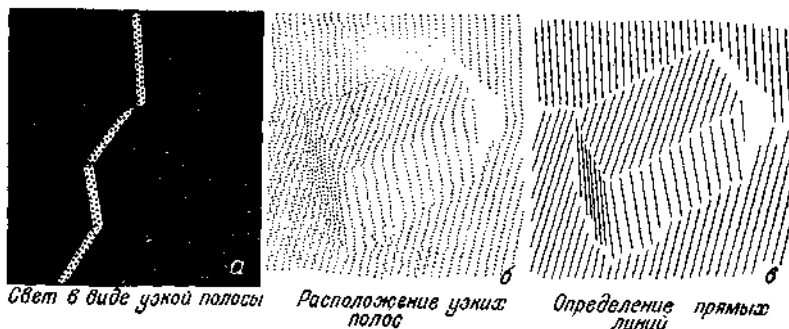
Рис. 9. Обработка информации, полученной при проецировании на предмет узких полос света а — узкая полоса света; б — конфигурация полос; в — выявление прямых линий
