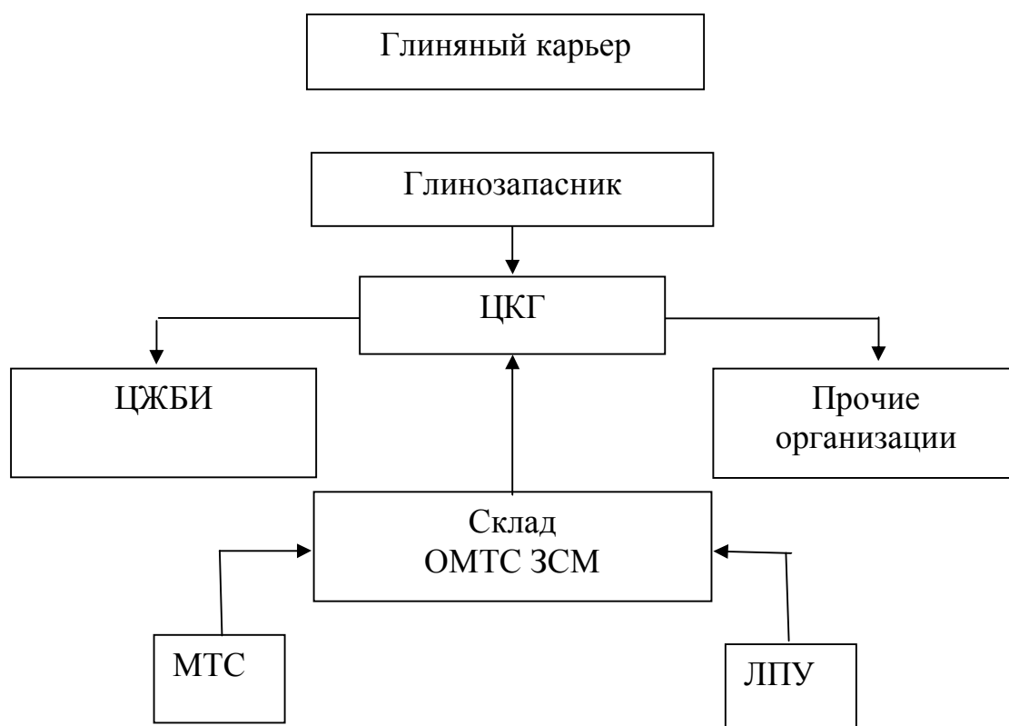
Рис. 3.11 – Технологическая схема цеха керамзитового гравия
